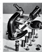
Stativ mit einer Niederkaltlampe, die zur leichten Handhabung mit dem Mikroskopfuß durch eine Schiene verbunden ist. Daneben: Phasenkontrasteinrichtung.
