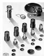
Phasenkontrasteinrichtung für das 100x. Rechts oben: Phasenkontrastkondensor. Links oben: Einfallslinse. Schräg in die Mitte: Vier Phasenkontrastobjektive. Darunter: Ringblende für Phasenkontrast und Ringblende zum Wechsel von Phasenkontrast zum Hellfeld.
