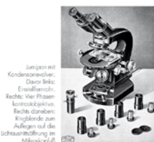
Phasenkontrasteinrichtung für das 100x. Rechts oben: Phasenkontrastkondensor. Links oben: Einfallslinse. Schräg in die Mitte: Vier Phasenkontrastobjektive. Darunter: Ringblende für Phasenkontrast und Ringblende zum Wechsel von Phasenkontrast zum Hellfeld.
